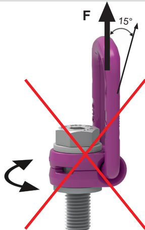
Abb. 7: Verbotene Drehbewegung bei Belastung in Achsrichtung
