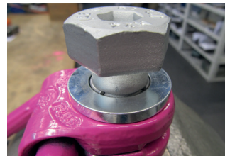
Abb. 10: Sprengring umlaufend vertieft in der Ansenkung positioniert
