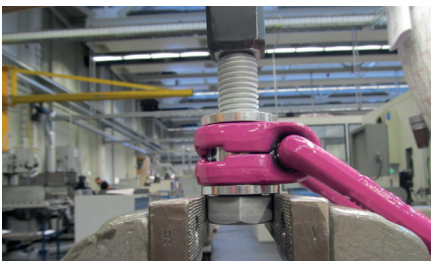
Abb. 8: Auflage des VLBG-PLUS zur Demontage der Schraube
