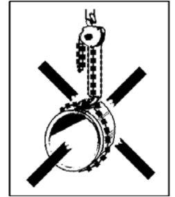
Fig 2 e Lastkättingen får ej användas som sling!
