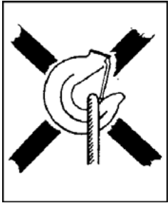
Fig 2 a Slinget belastar krokspetsen!
