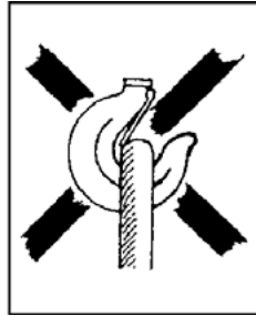
Fig 2 c Krokspärren blockerad!
