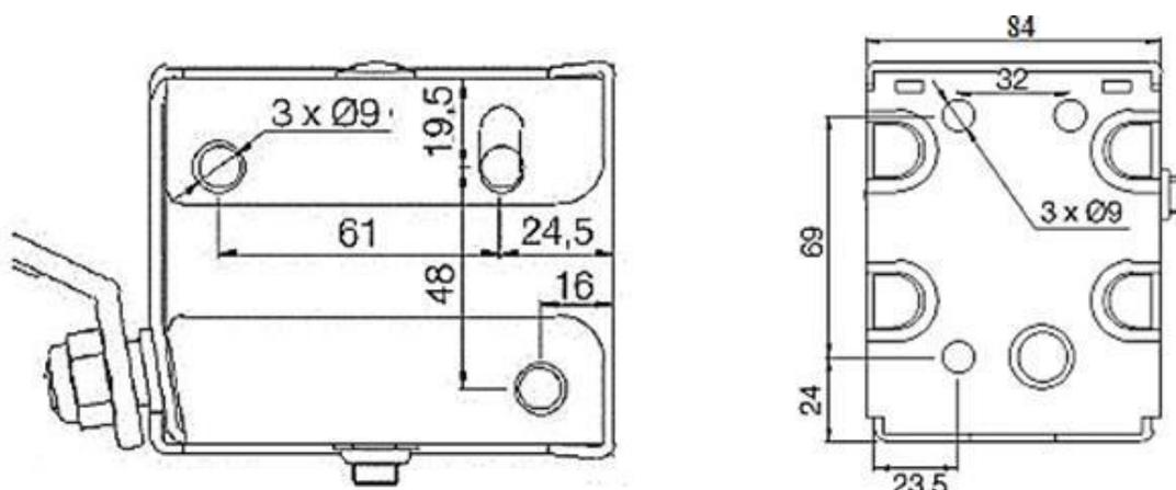
Rozměry základny (vlevo upevnění ze spodní strany, vpravo upevnění pro boční stranu).
