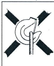
Obr. 3a Nežádoucí namáhání hrotu háku!
