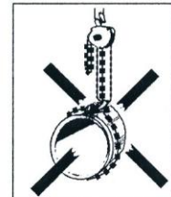
Obr. 3e Nosný řetěz nesmí být použit k zavěšení "na smýčku"!
