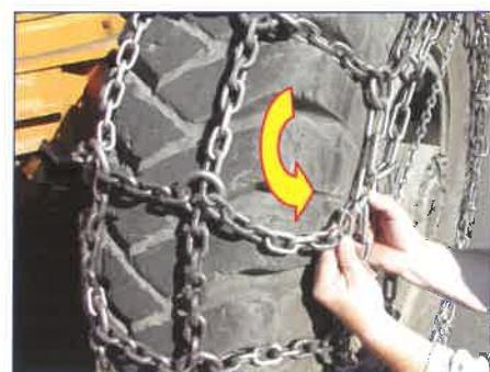
Napínací páku provlečeme některým článkem napinacího řetězu a po sklopení páky zhodnotíme napínací účinek. Je-li nedostatečný, je nutno páku opět uvolnit a navléknout do vzdálenějšího článku. V napnuté poloze páku zajistíme pomocí pojistného článku.
