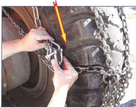
Nyní provedeme předběžné napnutí napinacího řetězu a současně upravíme polohy průvlečných článků tak, aby zaujaly polohu uprostřed úseků na boční řetěz.
