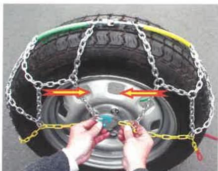
Lanko zasuneme za pneumatiku a celý řetěz na pneumaticce symetricky urovnáme.
