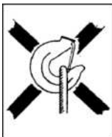
Fig 2 a Slinget belastar krokspetsen!
