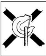
Fig. 2 a Slyngen belaster krokspissen!
