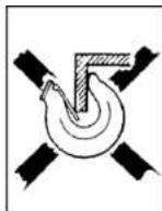
Fig 2 d Krokspetsen dessutom utsatt för böjpåkänning!
