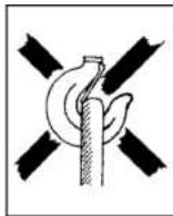
Fig. 2 c Kroksperran blokkert!
