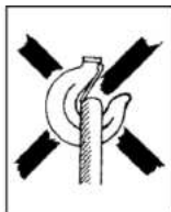
Fig 2 c Krokspärren blockerad!
