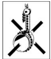
Fig. 2 e Lastekjettingen må ikke brukes som slynge!
