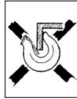
Kuva 2 d Koukun kärkeen vaikuttaa lisäksi vääntävä kosketusrasitus!
