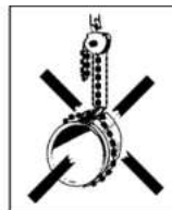
Fig 2 e Lastkättingen får ej användas som sling!
