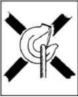
Kuva 2 a Silmukka kuormittaa koukun kärkeä!
