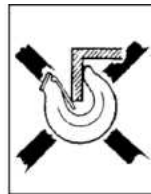
Fig. 2 d Krokspissen i tillegg utsatt for bøyningspåkjenning!
