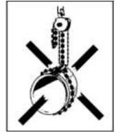
Kuva 2 e Kuormaketjua ei saa käyttää silmukkana!
