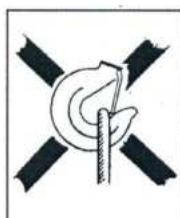
Obr. 3a Nežádoucí namáhání hrotu háku!
