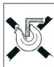
Obr. 3d Hrot háku je namáhán v ohybu!
