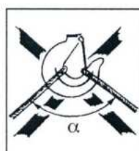
Obr. 3b Příliš velký vrcholový úhel vazáku!
