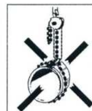
Obr. 3e Nosný řetěz nesmí být použit k zavěšení "na smyčku"!
