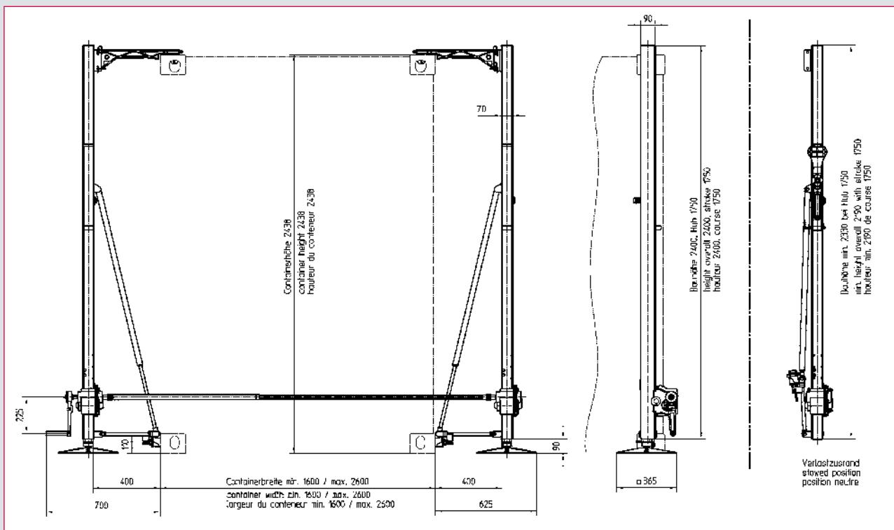
**Zum Absetzen des Containers vom LKW werden die Stützen in den ISO-Ecken des Containers montiert und verriegelt. Anschließend werden die Stützen bis zum Bodenkontakt ausgefahren und der Container angehoben, so dass der LKW ausfahren kann. Im Anschluß daran kann die Kabine entweder in die gewünschte Arbeitsposition gebracht und nivelliert, oder auf dem Boden abgesetzt werden.**
